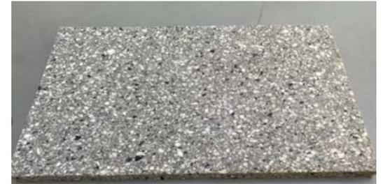
Mousse polyuréthane recyclé ep. 2 cm
