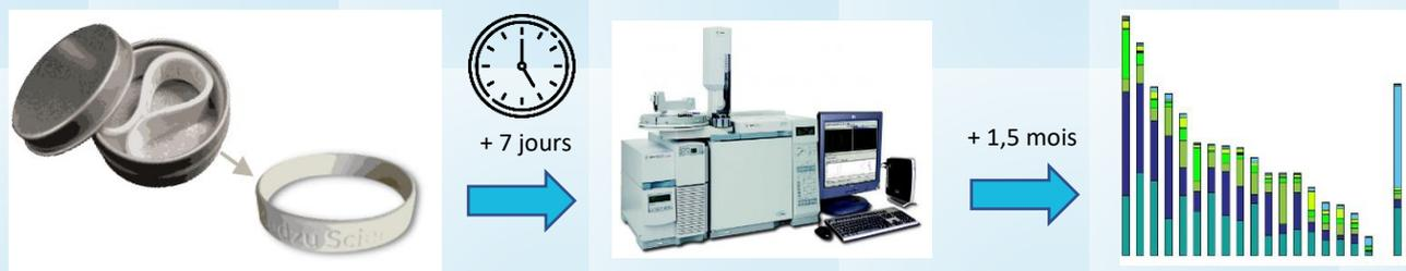
→ Les bracelets fournis par le laboratoire sont vierges de toute contamination par les phtalates (lavés avec un mélange de solvants) et protégés par une boîte métallique jusqu'à utilisation. La mesure débute à l'ouverture de la boîte et se termine quand les bracelets sont remis dans la boîte.
